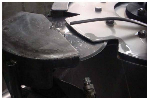
A Máquina Posicionadora Cortadora de Pescoço é uma solução tracionada pela linha para remoção de pescoços de frangos nas áreas de evisceração e corte. Esta máquina é especificamente projetada para proteger as asas da lâmina de corte do pescoço e preservar a qualidade da asa, aumentando assim o rendimento. A WLNSC mantém os frangos posicionados e tracionados pela linha.
