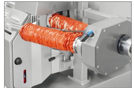
**Dos sistemas revólver: Cabezal tipo revólver en V o cabezal tipo revólver paralelo para un cambio rápido de la tripa.**
