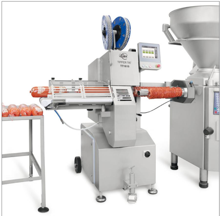
como al cerrar. El movimiento de la palanca de cierre del clip está a cargo de una leva abultada. Así, gracias a estas características constructivas, las clipeadoras automáticas dobles TT presentan un desgaste mínimo y una larga vida.
