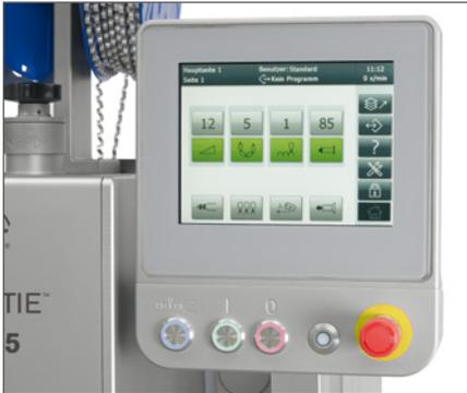
**El manejo de las doble clipadoras automáticas TT se realizan através de una pantalla táctil.**
