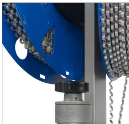
**El ajuste de la altura de clipeado es reproducible y se puede modificar desde fuera en la máquina.**
