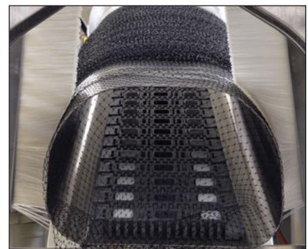
Optionales Rollenband im Rohr unterstützt die Produktförderung durch die Rutsche.
