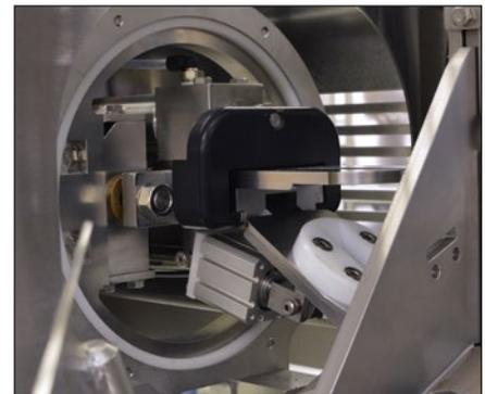
Die als Option erhältliche Grifffunktion produziert durchgängig Schlaufen in der korrekten Größe ohne Netzabfälle.
