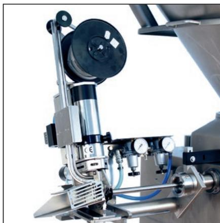
Компактное крепление клипсаторной головки.
