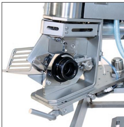
Простое открывание клипсаторной головки для быстрой смены оболочки.
