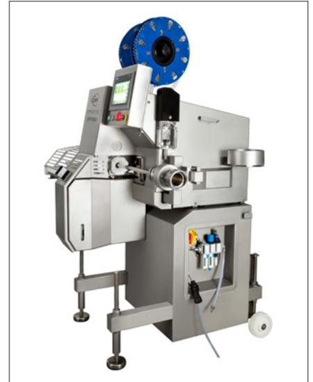
Interruptor de red principal y todas las conexiones se han integrado con seguridad en el lateral de la máquina
