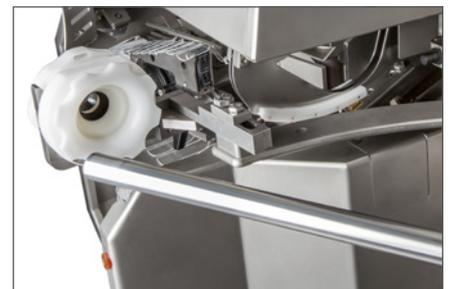
Freno de tripa con liberación rápida tipo "Quick-Release" para un cambio rápido de la tripa.
