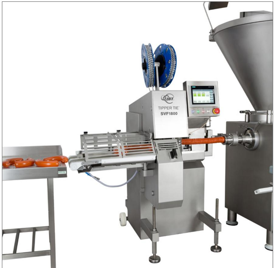
La SVF1800 y todas sus palancas de accionamiento se han construido con acero inoxidable de larga duración. Todos los elementos de la impulsión por leva le confieren a la SVF1800 una larga vida útil y un desgaste mínimo.
