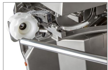
Quick-Release Darmbremsendesign für schnelle Darmwechsel.
