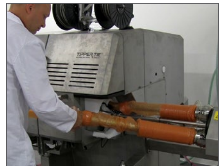
Un cabezal tipo revólver giratorio permite un cambio de la tripa prácticamente sin tiempos improductivos
