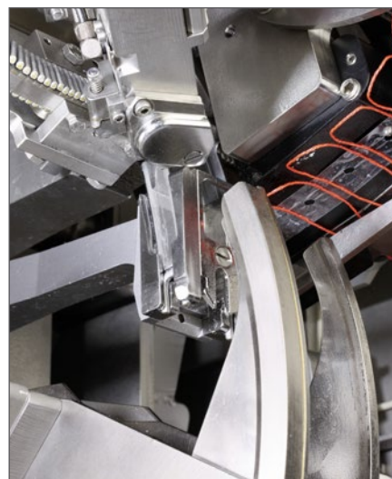
Técnica de clip "ida y vuelta" tipo Shuttle: división y clipeado – de alta precisión, rápido, con reproducibilidad de calibre y tratamiento cuidadoso de la tripa.
