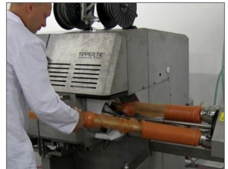
**Optionale Doppelrohrspulen für praktisch unterbrechungsfreie Darmwechsel**
