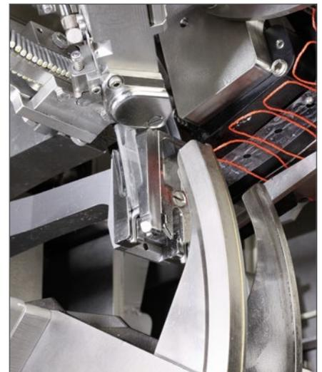
Shuttle-Clip-Technik: Verdrängen und Clippen – hoch präzise, schnell, kalibertreu und darmschonend
