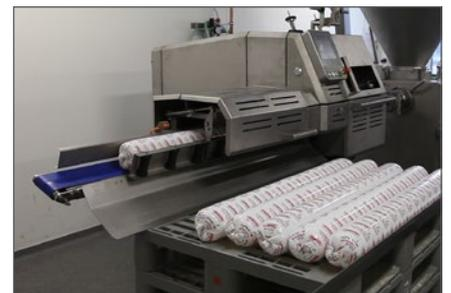
Konfiguration mit seitlichem Auslauf für geringeren Platzbedarf
