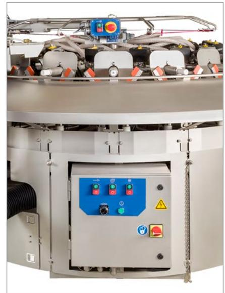
Простые и обзримые панели управления позволяют без труда управлять важными функциями, как то: пуск/стоп, вакуумный насос, поворотный стол с продуктами и эвакуатор отходов упаковки.
