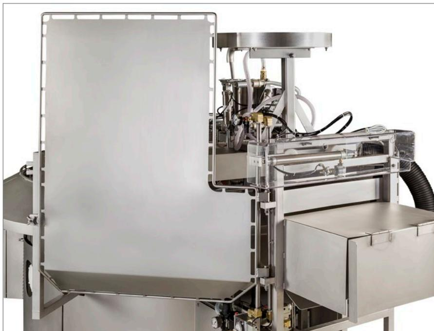
Система выгрузки, расположенная рядом с защитным экраном, эффективно перемещает продукт к конвейеру или непосредственно в термоусадочную камеру.
