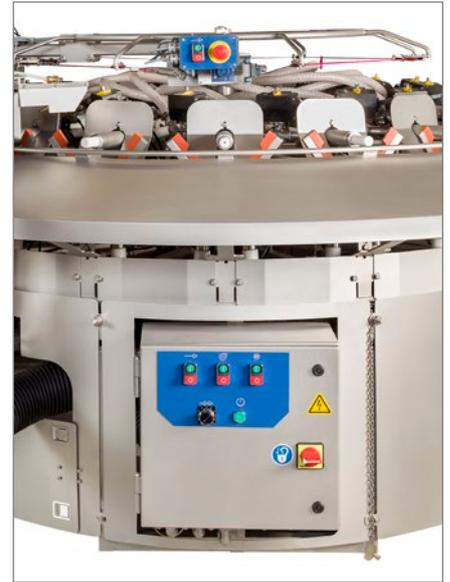
Los tableros de control sencillos y muy visibles facilitan el manejo de funciones vitales como arranque / parada, bomba de vacío, mesa de producto giratoria y eliminación del extremo de la bolsa.
