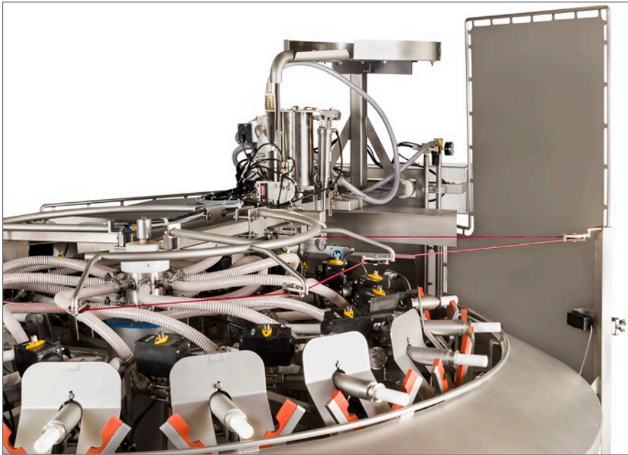
Neue Designfunktionen wie die vergrößerte Schutzblende und das rote Sicherheitskabel über dem drehbaren Produkttisch erhöhen die Sicherheit für den Bediener.
