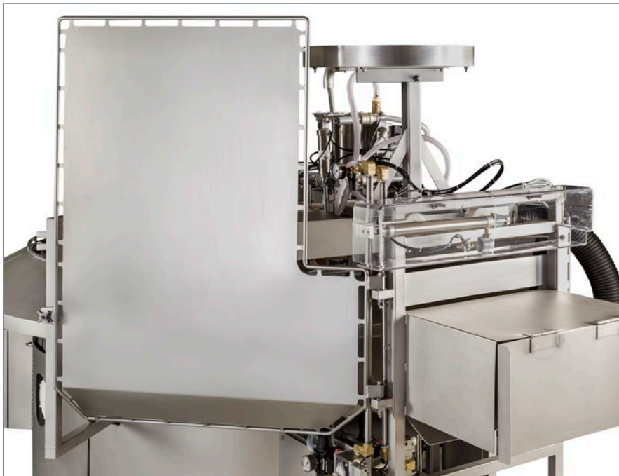
Die Ausleitung neben dem Schutzschirm leitet das Produkt zuverlässig auf ein Ausleitungsförderband oder direkt in einen Schrumpftunnel.
