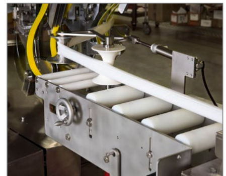
Cuando se dirige al plato giratorio, el tubo sellado se llena por medio de una bomba constante de transporte con el producto emulsionado.
