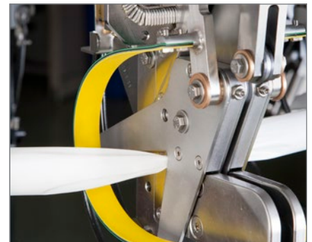
La placa de sellado contrae el tubo llenado y lo cierra de modo seguro con clips dobles.
