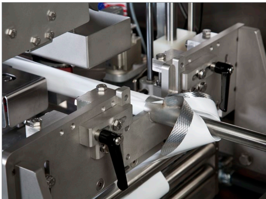
La lámina económica plana sobre rollos se modela en un envoltorio.
