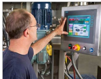
La operación y el análisis de potencia se efectúan simple e intuitivamente a través del mando HMI con pantalla táctil.
