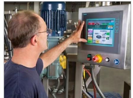
Über die HMI-Touchscreen-Steuerung erfolgen Betrieb und Leistungsanalyse einfach und intuitiv.
