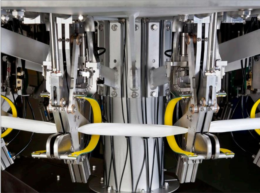
Der Rota-Clip kann über 330 abgedichtete und verschlossene Einzelpackungen pro Minute herstellen.
