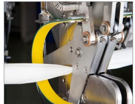
Die Dichtungsplatte rafft den befüllten Schlauch zusammen und verschließt ihn sicher mit Doppelclips.
