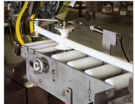
Der abgedichtete Schlauch wird auf dem Weg zum Drehteller mit Hilfe einer konstanten Förderpumpe mit dem emulgierten Produkt befüllt.
