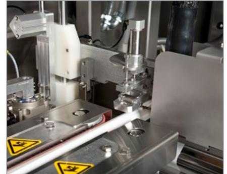
Der kontinuierliche Folienantrieb führt den Schlauch unter der Dichtungseinheit vorbei, die die Wärme- oder Klebedichtung vornimmt.
