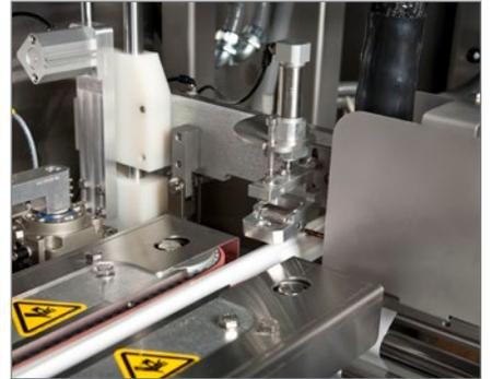
连续动作的薄膜驱动设备在密封装置之下移动包装管，密封装置通过热或密封胶进行密封。
