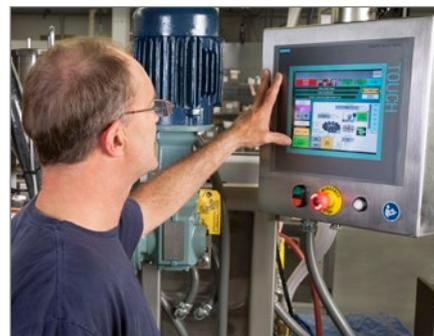
人机界面（HMI）触摸屏控制系统使操作和性能分析直观方便。
