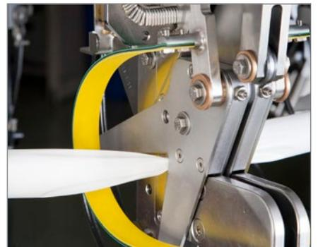
密封板夹紧已填充包装管，并可可靠地完成两次夹封。
