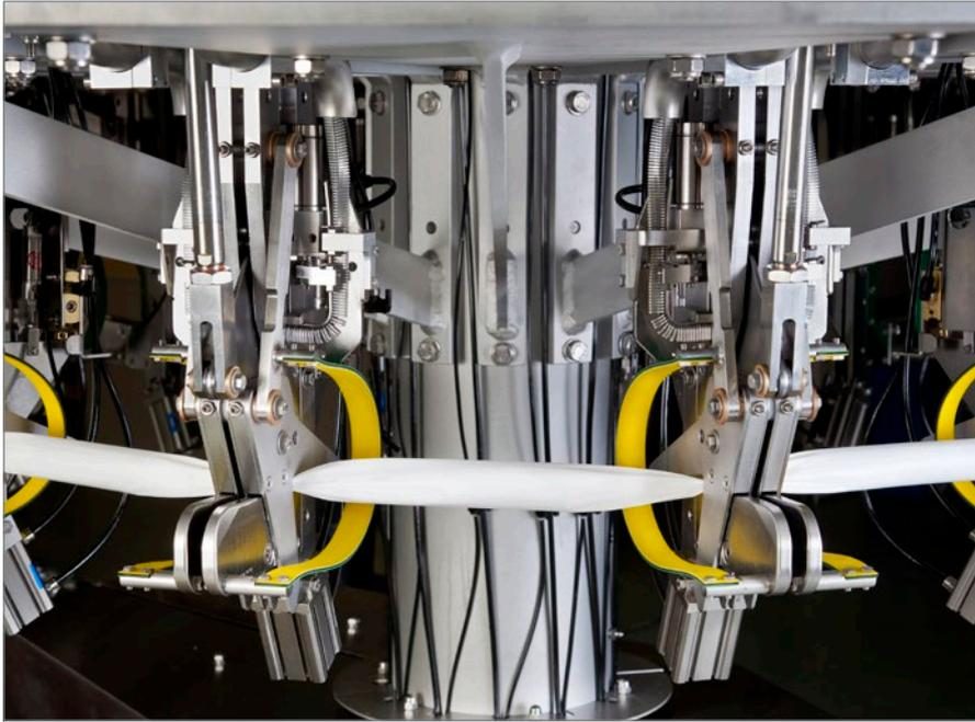
Rota-Clip封装机每分钟可以生产超过330个密封和封装的包装件。
