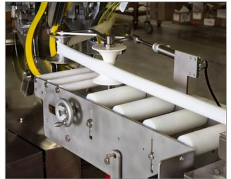
密封管移动到旋转台时通过一个恒定输送泵在其中填充乳化产品。
