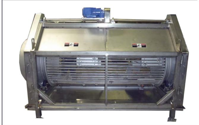
Prime BT-Serie Cilindro Escurridor de Aves ha sido diseñado para remover el exceso de agua de adentro de la piel del ave, típicamente después del enfriado. Construido en acero inoxidable, con un diámetro de malla filtrante de 38 pulgadas conectados a 2 motores de 3 hp, el BT Serie rota y oscila las aves de forma segura y efectiva sin ningun daño al mismo.
