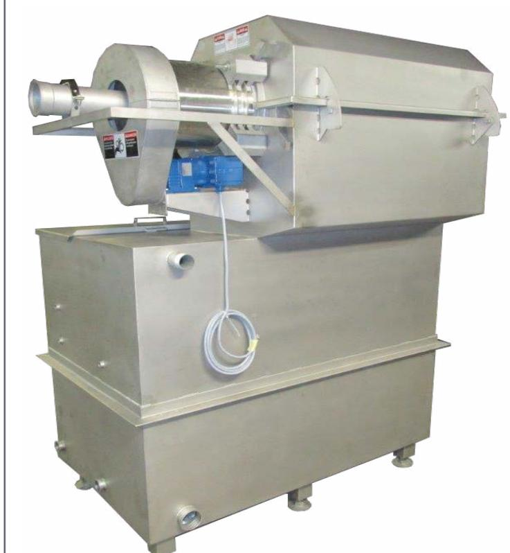
El filtro de agua y sistema de reuso Prime retira partículas arriba de .015 pulgadas de tamaño, en volúmenes que varían de 50 -200 GPM. Un típico sistema incluye un tambor cilíndrico con mallas de alambre de acero inoxidable (LPS - 112) y puede incluir un tanque integrado (LPS -112-TS).
