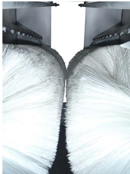
A Pré Escaldadora de Aves é equipada de cerdas rígidas para remover material fecal, que poderiam entrar no tanque de escaldagem, diminuindo assim a carga de contaminantes na água de escaldagem.
