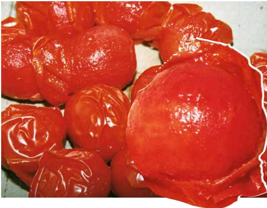
Tomates à la sortie de la soupape d'extraction, après échaudage et refroidissement sous vide
