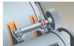
Afin d'améliorer les performances et de réduire l'entretien, l'arbre longitudinal unique a été remplacé par des moteurs d'entraînement et des arbres auxiliaires, montés directement sur la grande couronne.
