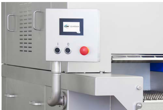
Standard Touchpanel zur Steuerung der Grundfunktionen, inklusiv Transport- und Spülfunktion
