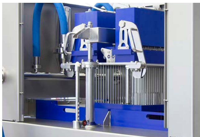
Cap de injectare și de frăgezire (dreapta) cu amortizare elastică, ace de injectare cu diametrul de 2 mm, 3 mm sau 4 mm, cuțit de frăgezire cu vârf șlefuit (diametru de 4 mm)
