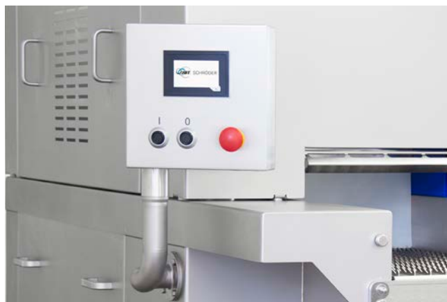
Standardowy dotykowy panel sterowania podstawowymi funkcjami, w tym funkcjami transportu i płukania
