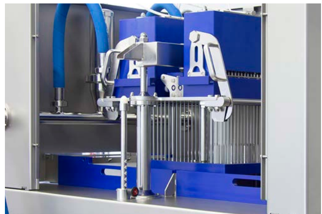
Głowica iniekcyjna i skruszająca (po prawej stronie) ze sprężynowaniem, igłami iniekcyjnymi o średnicy 2 mm, 3 mm lub 4 mm, nóż skruszający ze szlifowaną końcówką (średnica 4 mm)
