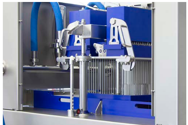
Tête injection et attendrissage (à droite) avec amortissement, aiguilles d'injection (2 mm, 3 mm ou 4 mm de diamètre), couteaux attendrisseurs à pointe aiguisée (4 mm de diamètre)
