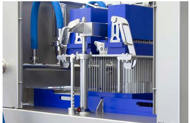
Cabezal de inyección (Izquierda) y Cabezal Tenderizador (derecha) ambos con bloque de retracción. Las agujas de inyección pueden ser de 2 mm, 3 mm o 4 mm de diámetro. Las cuchillas tenderizadoras tienen 4 mm de diámetro
