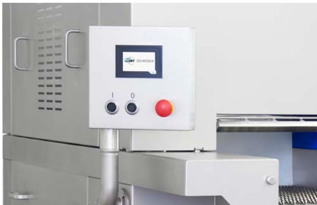
Panel táctil que controla todas las funciones básicas, incluyendo el tipo de transporte y función de limpieza
