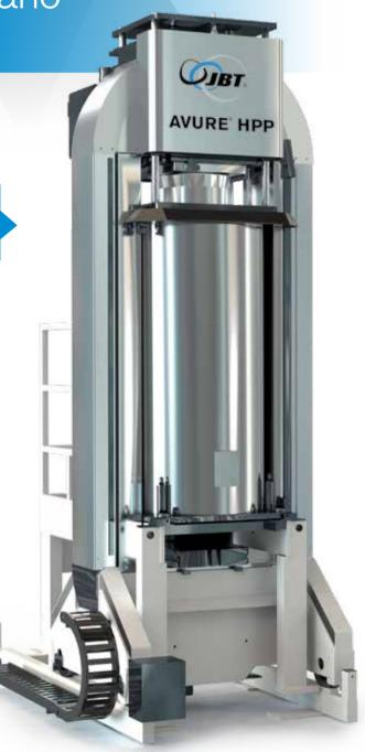
AV-S es el único sistema HPP diseñado especificadamente para el sector del procesado del marisco. Su diseño vertical aumenta un 30% el ratio de separación de la carne comparado con otros métodos, evitando al mismo tiempo dañar la máquina.
