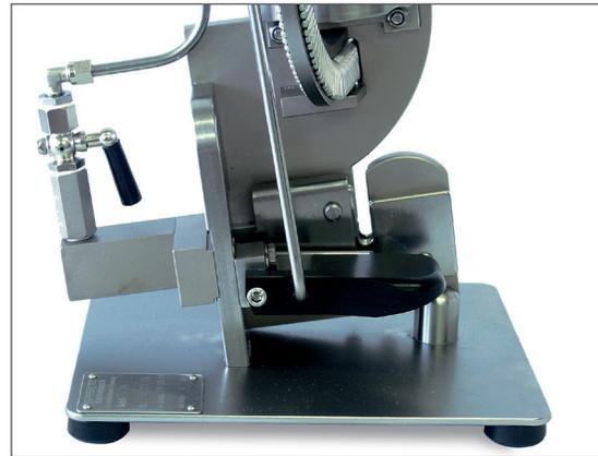
**Accionamiento de la palanca de detección y cuchilla desconectable.**
