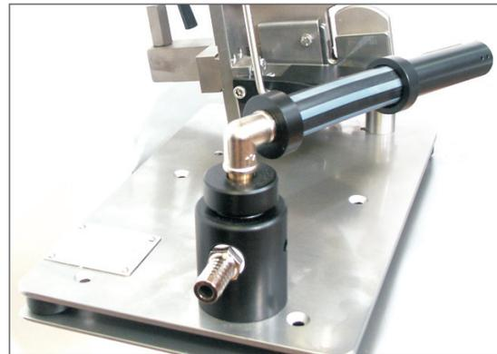
**Schwenkbares Absaugrohr für Vakuumverpackungen**
