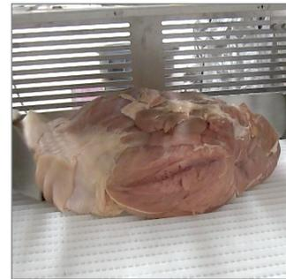
Schwerkraftzuführung und Einlegekammer, das für die meisten Fördermethoden geeignet ist. Die Einlegekammer positioniert das Produkt automatisch und leitet es ins Rohr. Die korrekte Platzierung des Produkts in der Einlegekammer ist wichtig für den effektiven Einschub in das enge Netz und für die Herstellung einer Qualitätsverpackung. Die Einschub- und Clipprozesse der Maschine sind identisch mit dem Modell TN2002C.
