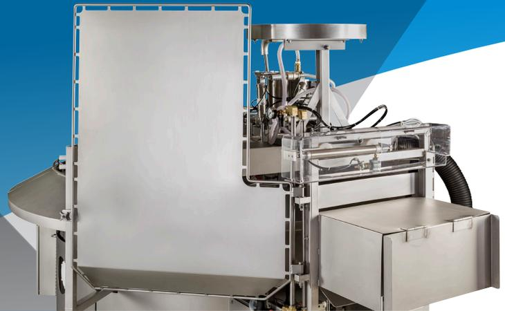
La descarga, situada al lado de la pantalla de vigilancia, transfiere con eficiencia el producto a la cinta de transporte o directamente al túnel retráctil.
