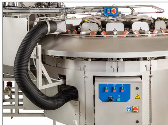
Einfache, gut sichtbare Bedienpanels vereinfachen die Steuerung der wichtigsten Funktionen wie Ein-/Ausschalten, Vakuumpumpe, drehbarer Produkttisch und Entsorgung von Beutelresten.
