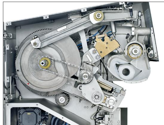
**Alle Antriebshebel sind aus massivem, rostfreiem Stahlguss gefertigt. Die elektronische Clipverschlusskraft-Überwachung „NewCon“ erhöht die Produktionssicherheit.**
