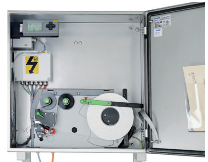
Etiketten und Printsystm sind in einem hermetisch abgedichteten Edelstahl-Gehäuse eingebaut
