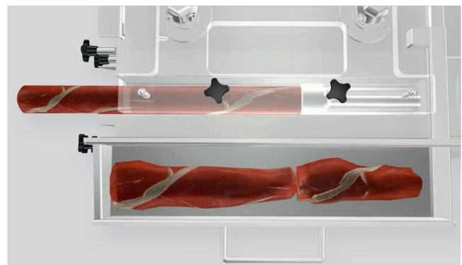
Während das Produkt ausgestoßen wird, kann die Schublade erneut befüllt werden
