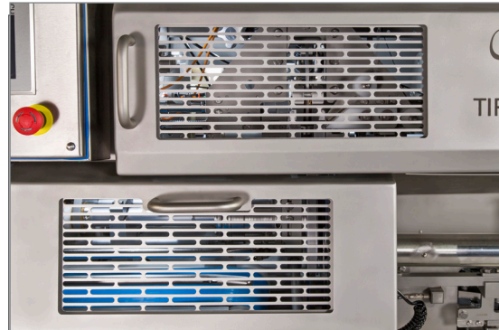
Auf Wunsch können an Stelle des trübungsbeständigen Polykarbonats auch Edelstahlfenstereinsätze bestellt werden.
