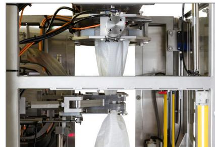
Automatisches Befüllen und Clippen ohne manuelle Arbeitsschritte für weniger Arbeitsaufwand.
