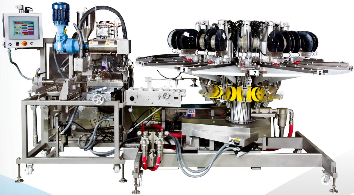
将可泵送产品自动热封与夹封在软包装中
