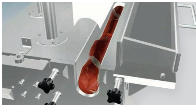
Carnea este introdusă în magazie prin intermediul unui echipament cu sertare
