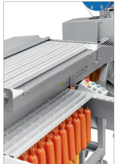
Le magasin pivotant de barre de fumoir s'adapte à 22 barres de fumoir.
