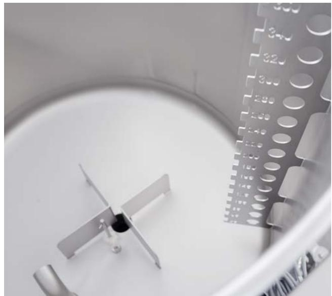
**Füllstandsanzeige und Strudelbrecher zur Optimierung der
