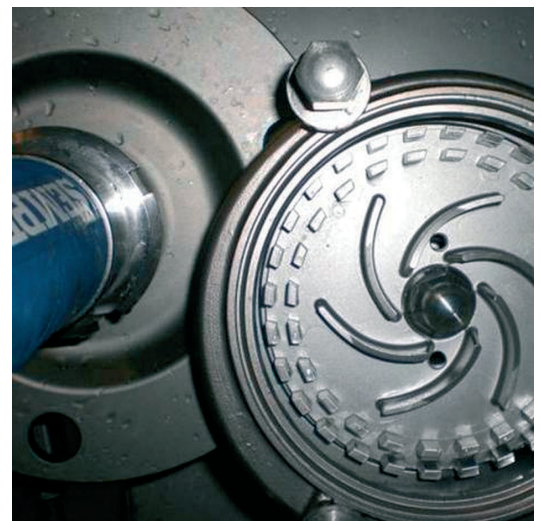
Abb. 1: Die Flügelräder einer Shearpump halten die Lakebestandteile in der Schwebelage.
