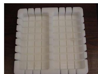
El Cortador de Porciones PC – 1 de Prime Equipment Group es una solución simple y eficiente para cortar en porciones la carne de la pechuga, trozos, carne negra, carne roja y pescado a especificaciones de formas y pesos específicos. El PC-1 es adaptable para cualquier configuración de producto final.
