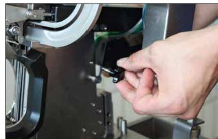
**De fácil mantenimiento: cambio de cuchilla sin necesidad de herramienta**
