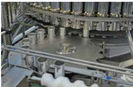
La conception de l'Unifiller permet une immense variation de produits : depuis les produits faiblement visqueux, sans morceaux, jusqu'aux produits extrêmement visqueux contenant des morceaux, remplis à chaud ou à froid. Les grands orifices d'amenée du produit et le trajet court du produit permettent l'utilisation de produits extrêmement visqueux, avec ou sans morceaux.
