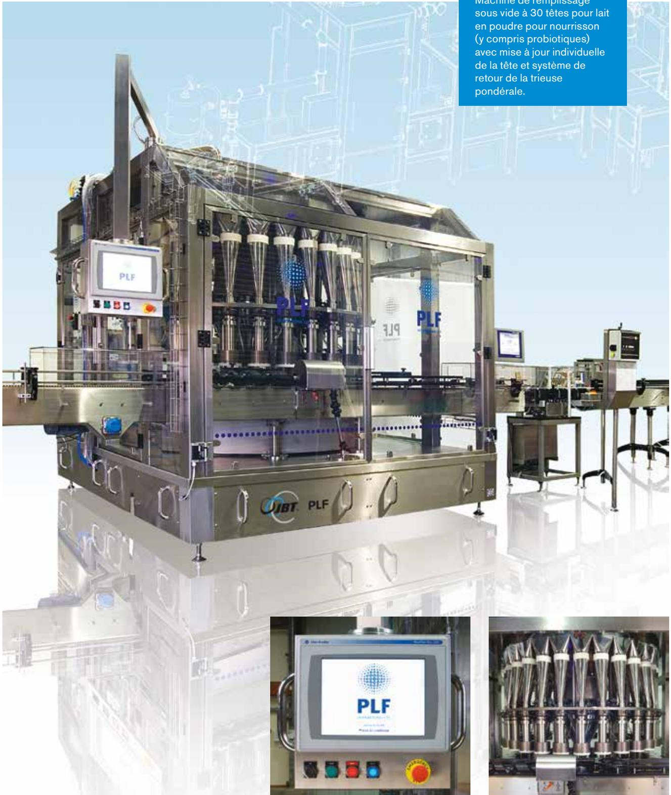
Machine de remplissage sous vide à 30 têtes pour lait en poudre pour nourrisson (y compris probiotiques) avec mise à jour individuelle de la tête et système de retour de la trieuse pondérale.
