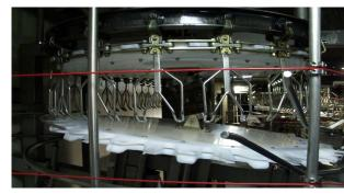
A HM-2 Prime, Separadora de Frango ao Meio separa o front half automaticamente e eficientemente. Operando a velocidades superiores a 180 aves/min., a HM-2 pode ser ajustada para remover mais costelas ou parte dorsal para maximizar o rendimento do leg quarter. A Halving Machine pode ser ajustada para cortar exclusivamente front half do dorso ou deixar o front half pendurado pela pele do dorso sendo removida pelo cortador de pele para maximizar o rendimento de pele e gordura do corte das pernas.
