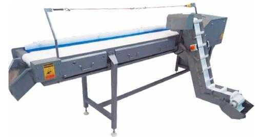
El Tectru RA 14,000 Pelador de Mollejas, distribuido por Prime, es una máquina de alta capacidad diseñada para partir las mollejas y posterior traslado a la banda transportadora de inspección. Las mollejas que requieren reproceso son llevadas a una ub-banda transportadora que las lleva a un banco repelador. Las mollejas reprocesadas son entregadas en otra banda de inspección para revisión final y proceso de nuevo si así lo requiere.
