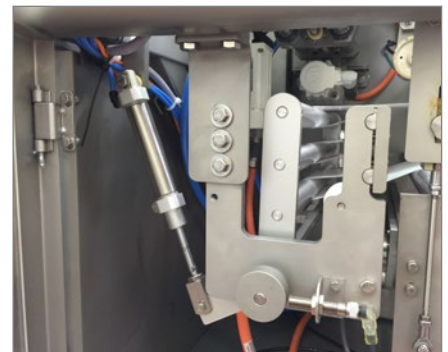
El rollo bailador mantiene una tensión consistente.
