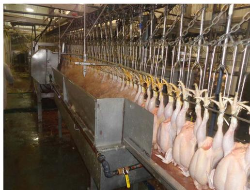
El Equipo Enfriador de Cascada doble (DCC-1) para pollos está diseñado para ser colocado después de la última estación de desplumado con la finalidad de enfriar inmediatamente las aves. Esto ayuda a solidificar la grasa que ha sido emulsificada durante el proceso de desplumado y escaldado, mejorando la eficiencia del chiller más adelante en la línea de proceso.
