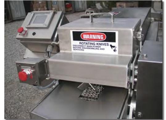
La unidad CFS-TSK-1 está diseñada para retirar eficientemente la carne y la piel de los muslos de pavo utilizando nuestros patentados conceptos de peladora sin cuchillas y los métodos de deshuesado por chorro de agua a alta presión.
